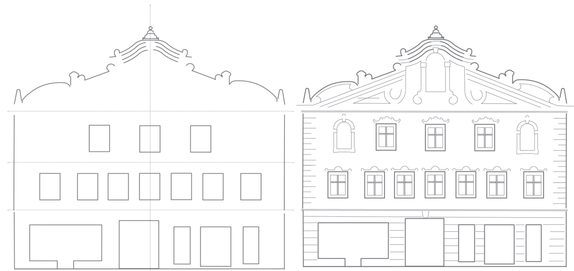
Abbildung 43 e (links) schematische Ansicht mit vertikaler und horizontaler Gliederungsstruktur Abbildung 43 f (rechts) Ansicht Fassade Darstellung D I S
